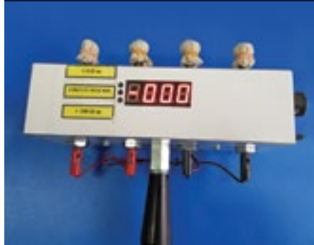
Fig. 1. Aparat destinat măsurării in situ a rezistivității electrice a structurilor de rezistență din beton armat. Caracteristici: măsurarea rezistivităților cuprinse în plaja 5 \Omega m \div 100 \Omega m , indicarea optică a valorilor sub 5 \Omega m și a celor peste 100 \Omega m
