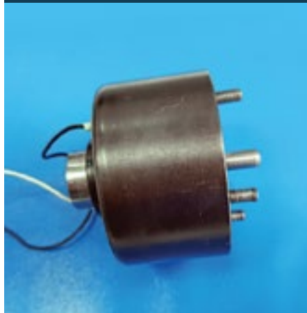
Fig. 3. Actuatorul electromagnetic cu acțiune proporțională, caracteristici: excursia echipamentului mobil este de 0 – 15 mm; frecvența semnalului dreptunghiular, f=24 kHz, factorul de umplere reglabil, k=10\% - 90\% , amplitudinea vârf la vârf U_{p-p} = 24 V
